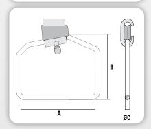
Finalidade: Conexão com cabos de alumínio CA e CAA ou cobre. Possibilita a derivação de um grampo de linha viva, derivações de até quatro conectores tipo cunha ou à compressão.
