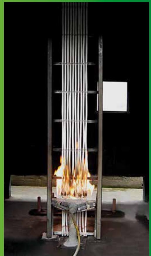
Prueba de llama según UL 1685
