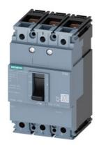
Interruptor automático 3VM1 IEC Frame 100 Clase de poder de corte B Icu=16kA @ 415V 3 polos, protección de distribuciones TM210, FTFM, In=20 A protección de sobrecarga Ir=20 A invariable protección de cortocircuito Ii=16 x In conexión plana con tornillos
