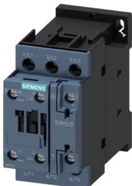
Contactor de potencia, AC-3 12 A, 5,5 kW/400 V 1 NA + 1 NC, 220 V AC 50/60 Hz, 3 polos tamaño S0, conexión por tornillo
