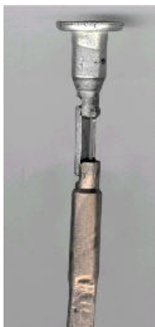
FOTOGRAFÍA 2 Fusible T - 140 Amp
