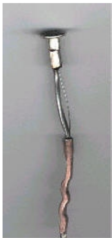
FOTOGRAFÍA 1 Fusible T - 30 Amp
