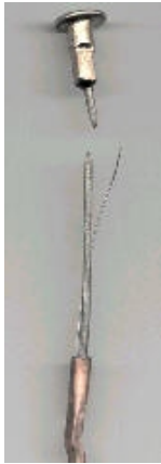
FOTOGRAFÍA 9 Fusible T - 30 Amp
