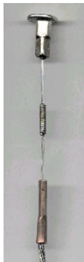
FOTOGRAFÍA 6 Fusible VS 6 Amp
